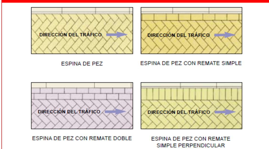
Figura 5. EJEMPLOS DE COLOCACIÓN EN PLANTA DE ADOQUINES EN ZONAS DE TRÁFICO RODADO.
